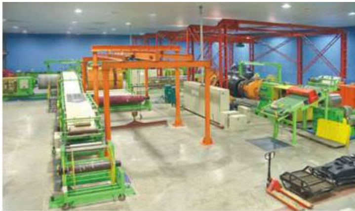
两鼓全钢载重子午线轮胎成型机
